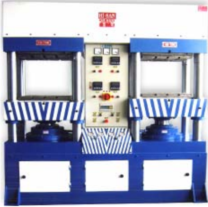
Resim 1.16: Tek etkili ağırlık etkisi ile geri dönüşlü hidrolik pres
